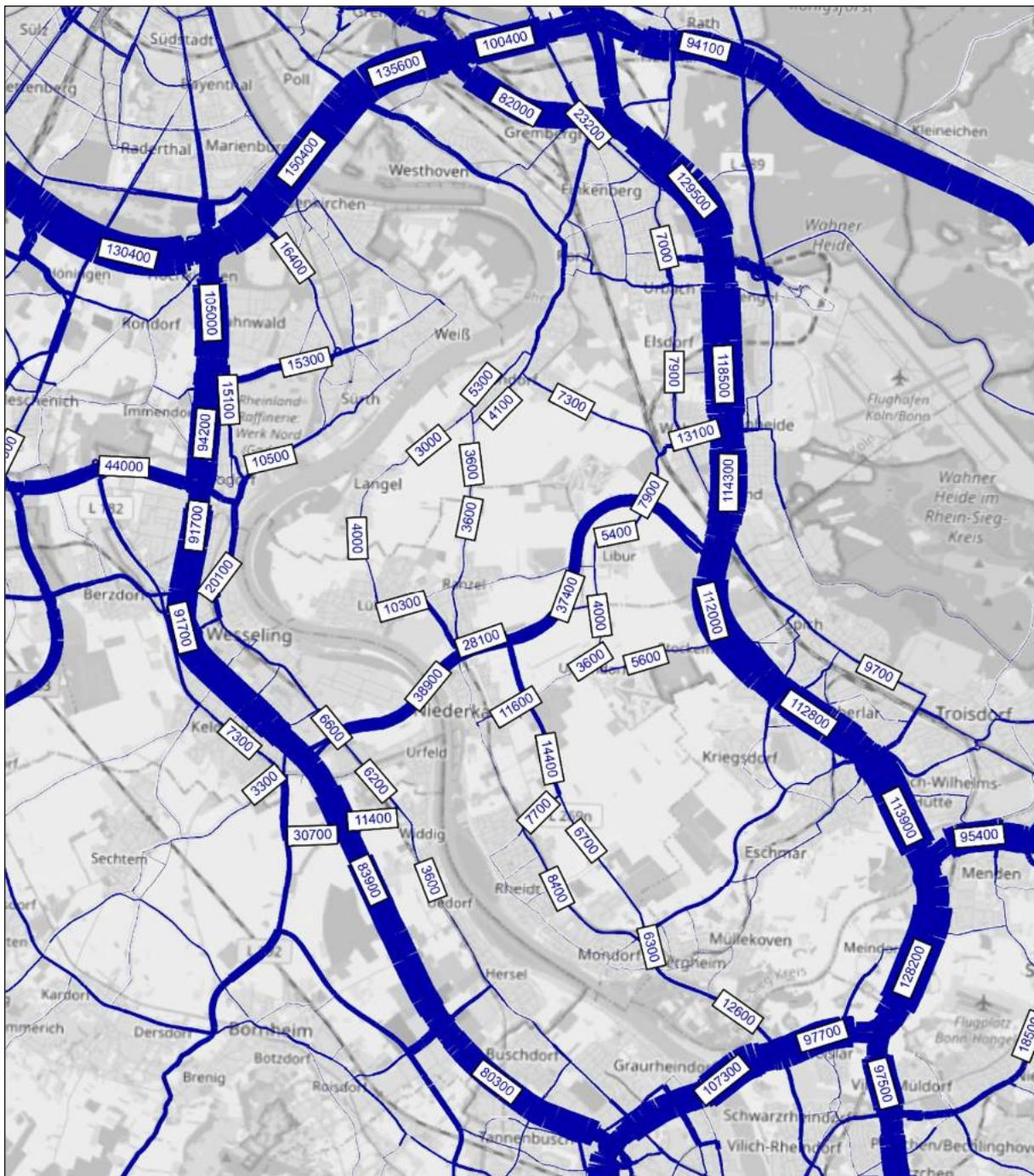
Abbildung 11: Durchschnittliche tägliche Verkehrsbelastungen (DTV) [Kfz/24h] für Variante 5B
