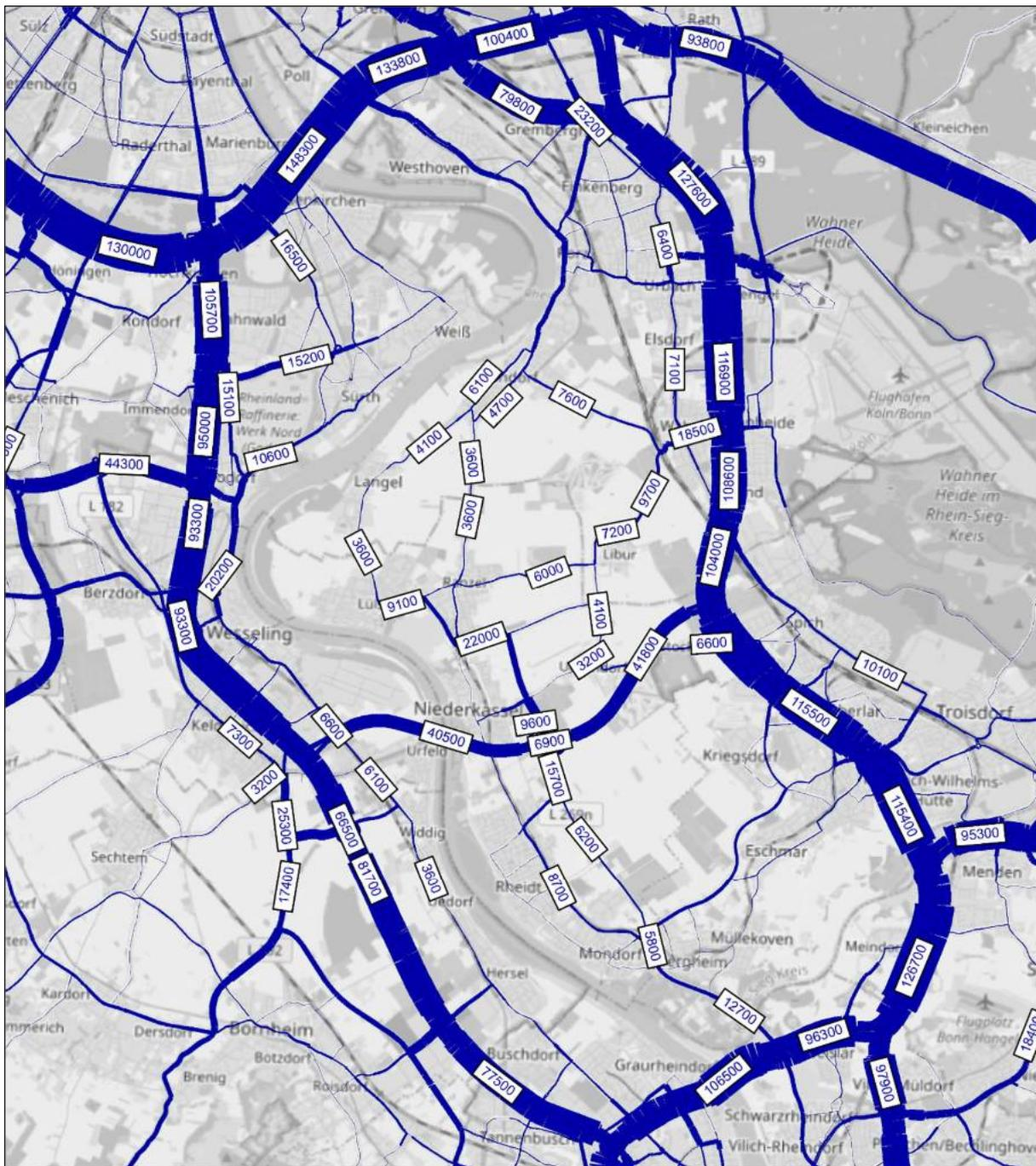
Abbildung 26: Durchschnittliche tägliche Verkehrsbelastungen (DTV) [Kfz/24h] für Variante 8B
