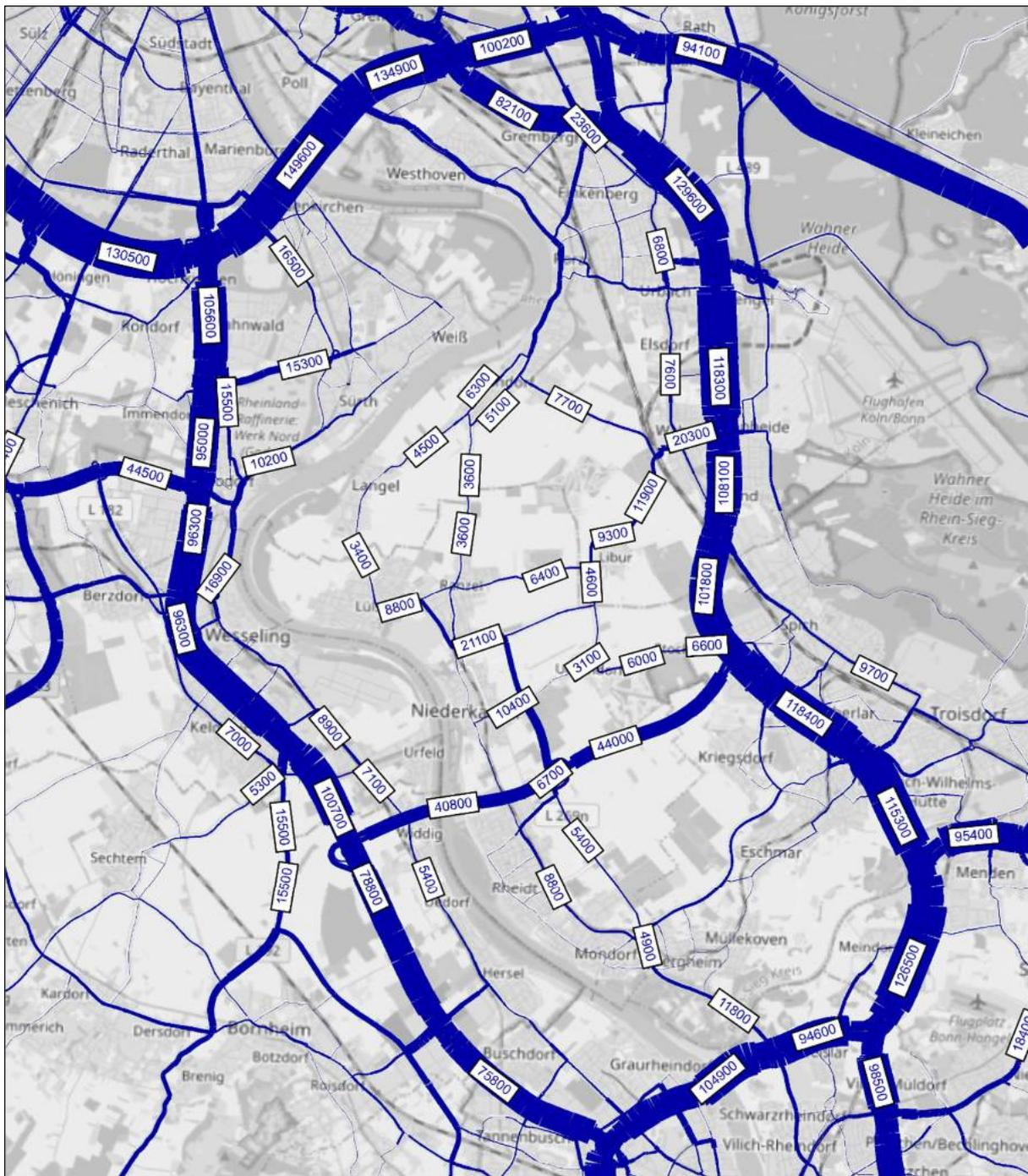
Abbildung 35: Durchschnittliche tägliche Verkehrsbelastungen (DTV) [Kfz/24h] für Variante 10T
