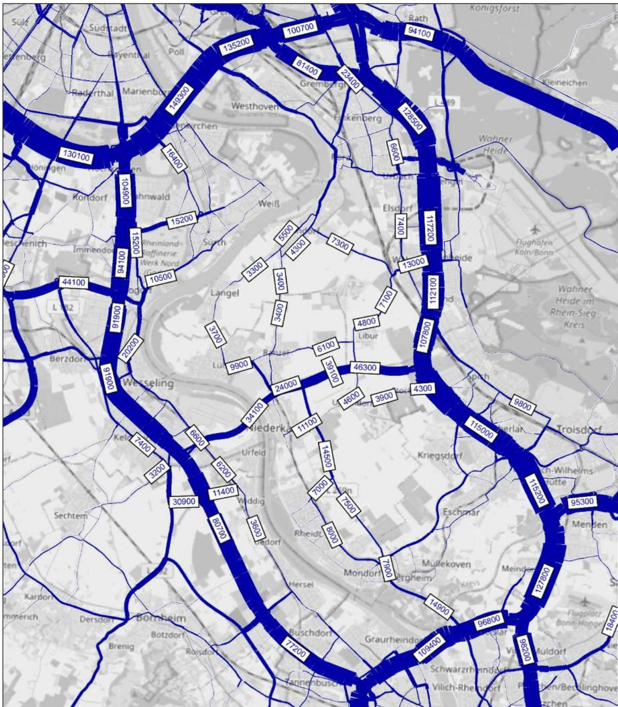
Abbildung 17: Durchschnittliche tägliche Verkehrsbelastungen (DTV) [Kfz/24h] für Variante 6aT
