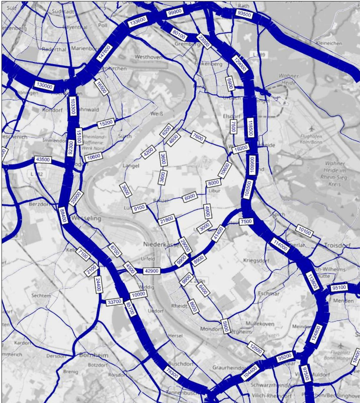
Abbildung 29: Durchschnittliche tägliche Verkehrsbelastungen (DTV) [Kfz/24h] für Variante 9aB
