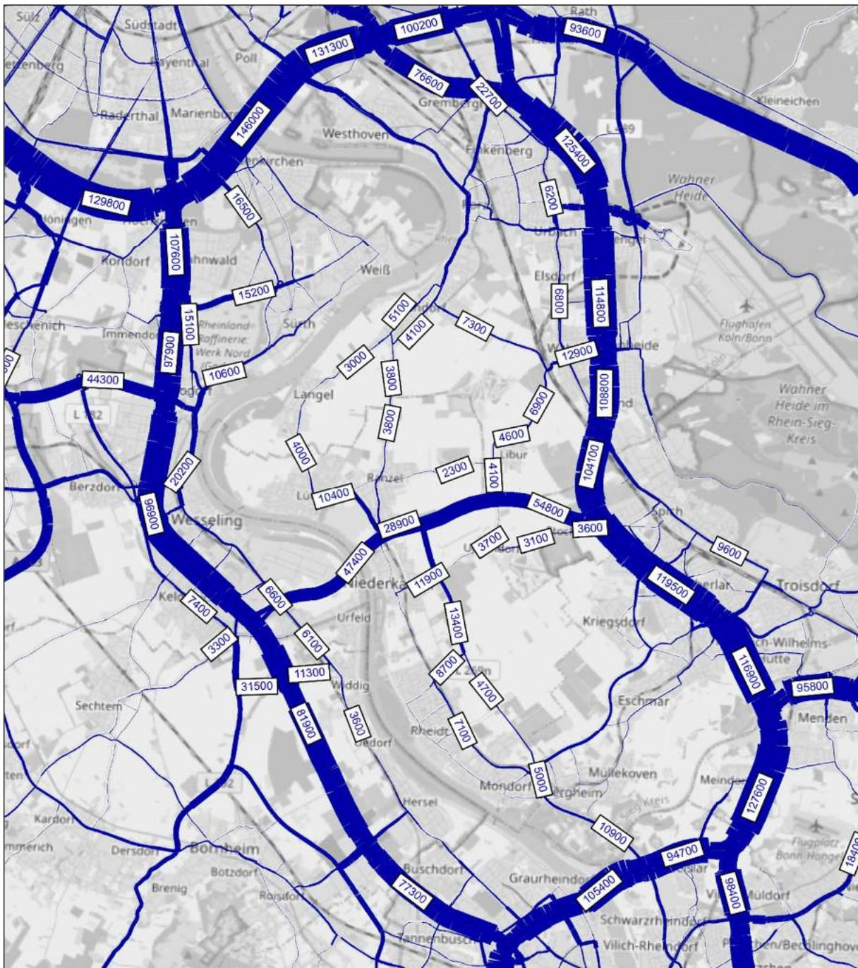
Abbildung 20: Durchschnittliche tägliche Verkehrsbelastungen (DTV) [Kfz/24h] für Variante 6bB
