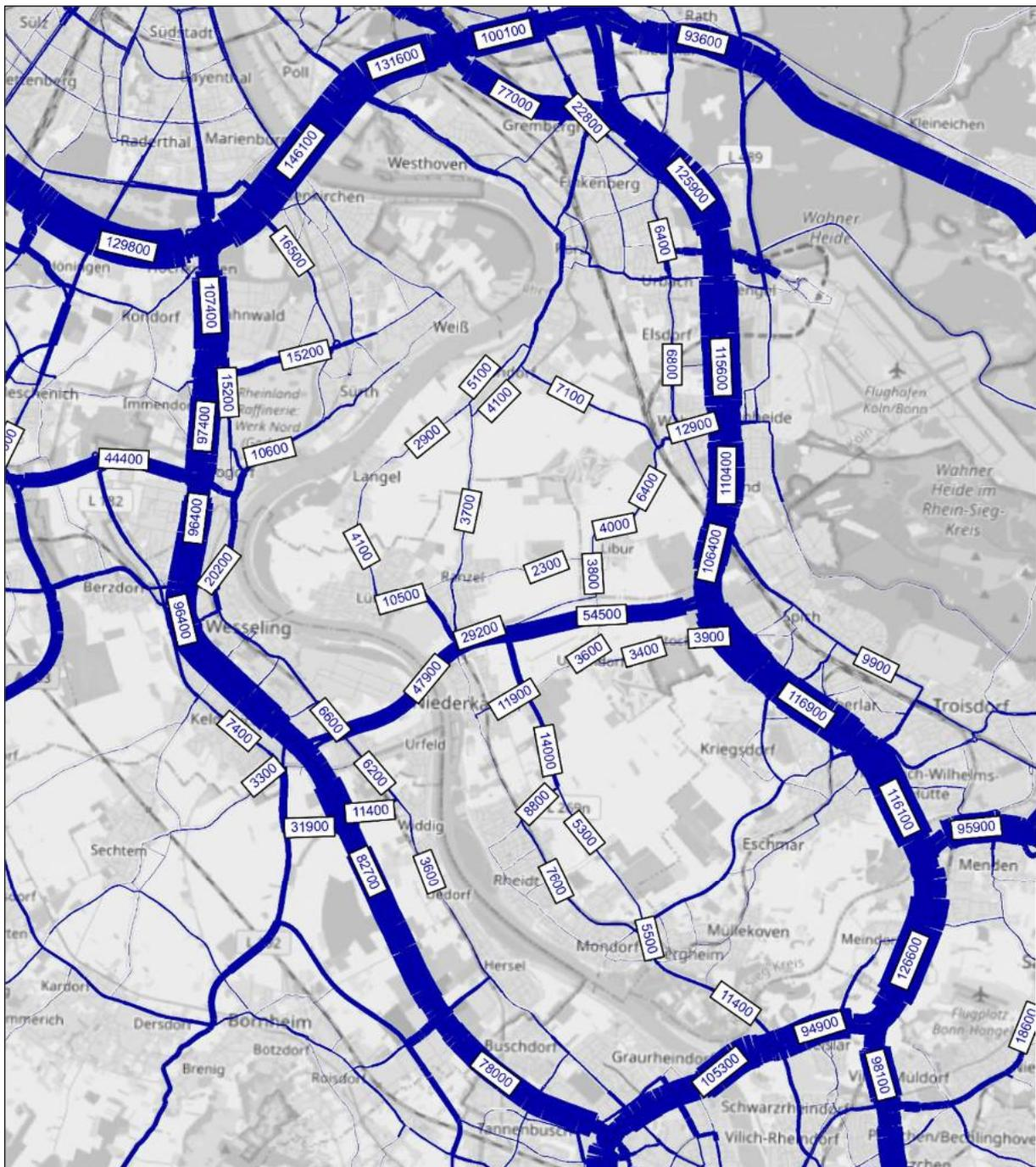
Abbildung 14: Durchschnittliche tägliche Verkehrsbelastungen (DTV) [Kfz/24h] für Variante 6aB
