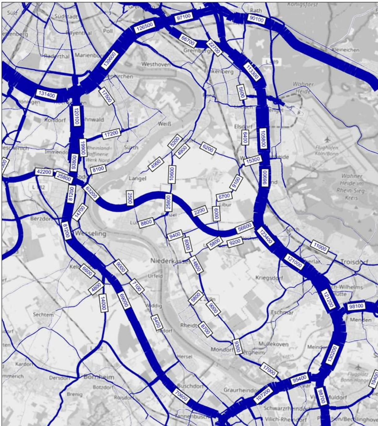
Abbildung 8: Durchschnittliche tägliche Verkehrsbelastungen (DTV) [Kfz/24h] für Variante 4B
